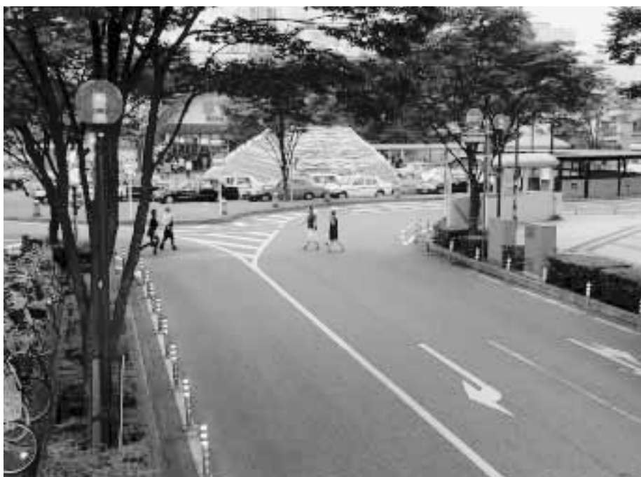
鉄道の駅前ロータリーです。タクシープールと“山”の向こう側が駅です。横断歩道が足りません。遠回りさせるには無理があります。(埼玉県草加駅にて撮影：杉田正明)
