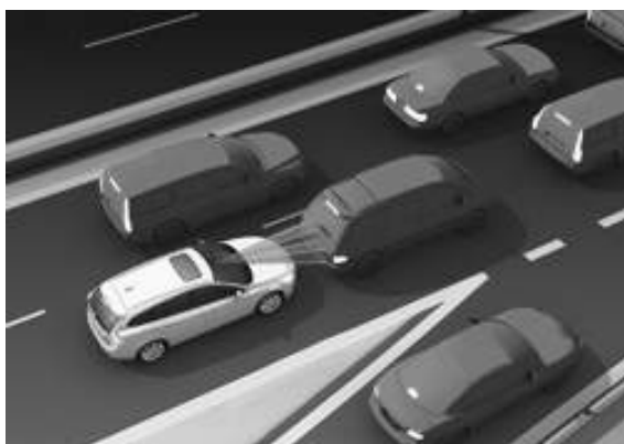
図8 ボルボシティセーフティ 赤外線レーザーによる障害物感知システム 出典：ボルボ自動車
