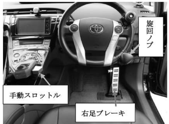
図12 大野式手動スロットル装置(プリウス)
