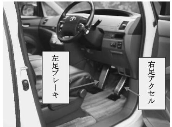
図15-1 大野式左足ブレーキシステム(側面)ベース車両：トヨタエスティマ
