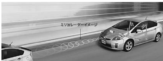
図7 トヨタ ミリ波レーダーによる障害物検知システム 出典：トヨタ自動車
