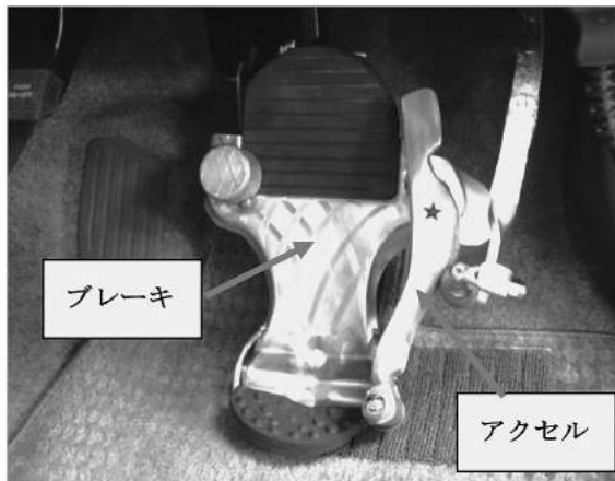
図11 ナルセペダル(ワンペダル) アクセル/ブレーキ操作に踏み換えが不必要 出典:ナルセ機材工業
