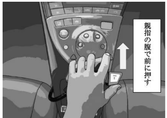
図13 大野式手動スロットル装置 操作方法
