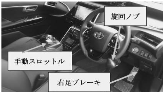
図14 トヨタミライに装着した大野式手動スロットル装置
